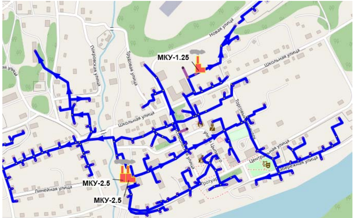
Рисунок 3.8 – Перспективные источники тепловой энергии, планируемые к вводу в эксплуатацию (МКУ-2,5 МВт - 2шт., МКУ-1,25 МВт.)
